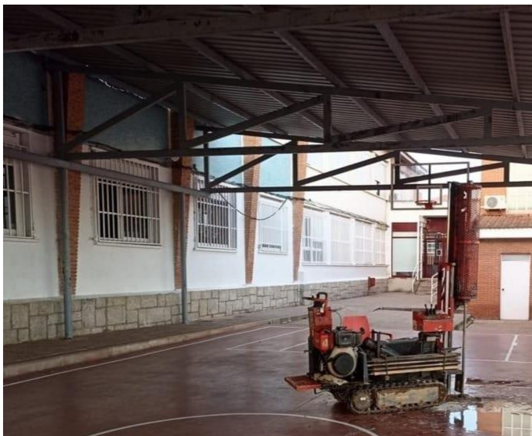
Figura Nº 2.- Trabajos para la realización de la penetración dinámica, tipo DPSH, referida en este documento como P-01.
